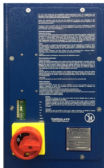
Figure 4 : Module de commande avec inverseur (2.30 SL à 2.40 SL)
