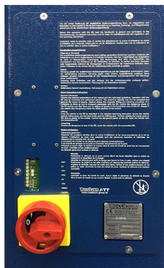
Immagine 4 Unità di sollevamento con commutatore-invertitore (2.30 SL fino a 2.40 SL)
