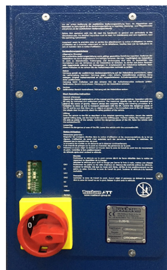
Figura 4: Unidad de mando con conmutador inversor (2.30 SL hasta 2.40 SL)
