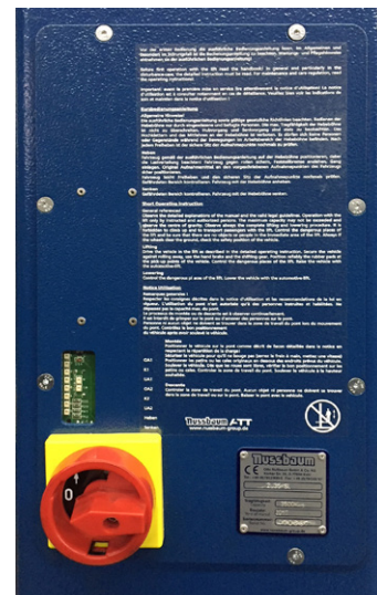
Bild 4 Bedieneinheit mit Wendeschalter (2.30 SL bis 2.40 SL)
