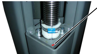
Immagine 18: Applicare dello smalto sigillante sul perno della madrevite di sollevamento
