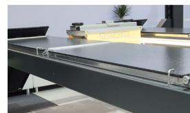
Doppelte Schiebeplatten zur Achsvermessung
